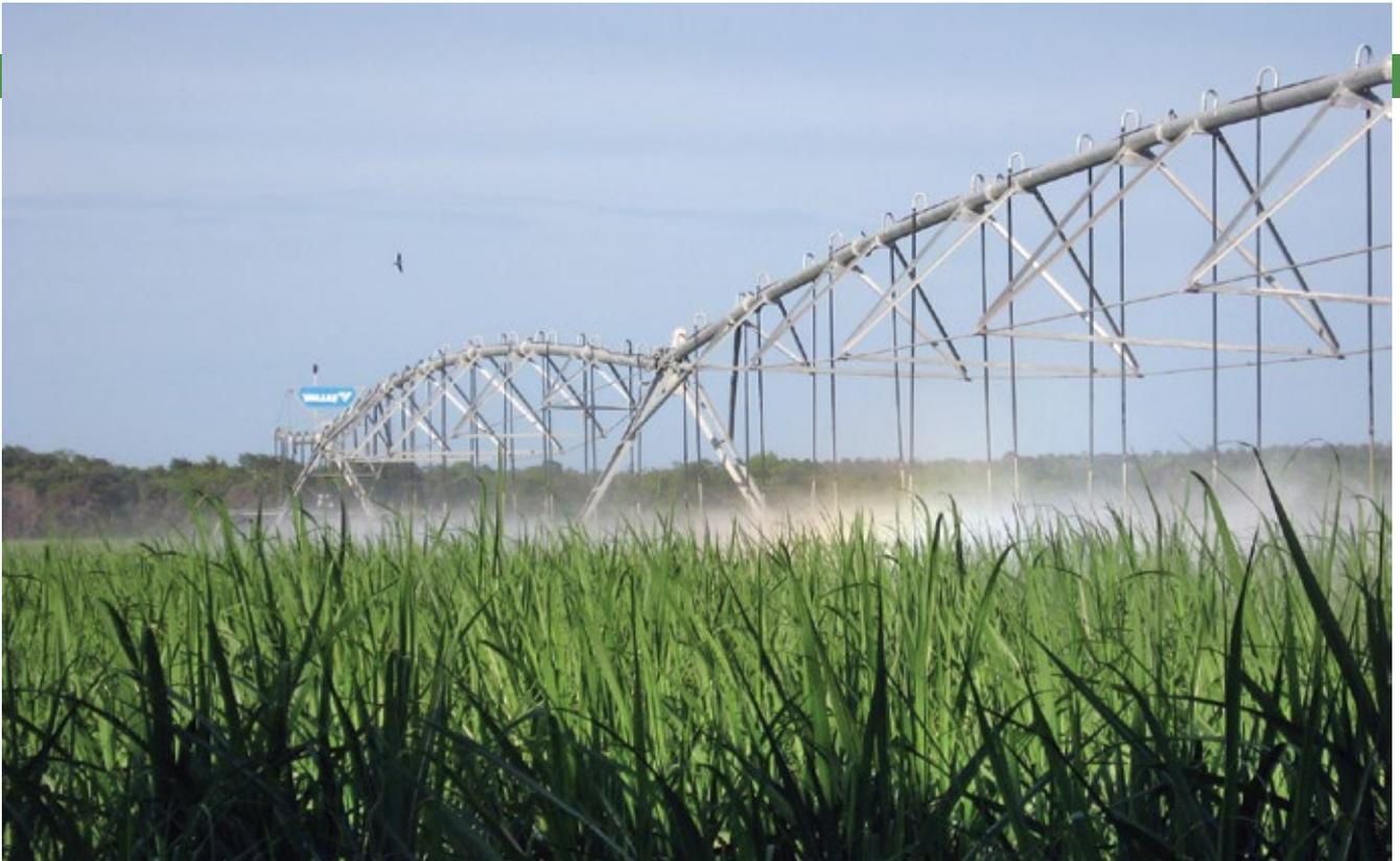
FIGURA 3 – Pivô central irrigando cana-de-açúcar com mangueiras de decida com altura regulável (fonte: Valmont).
