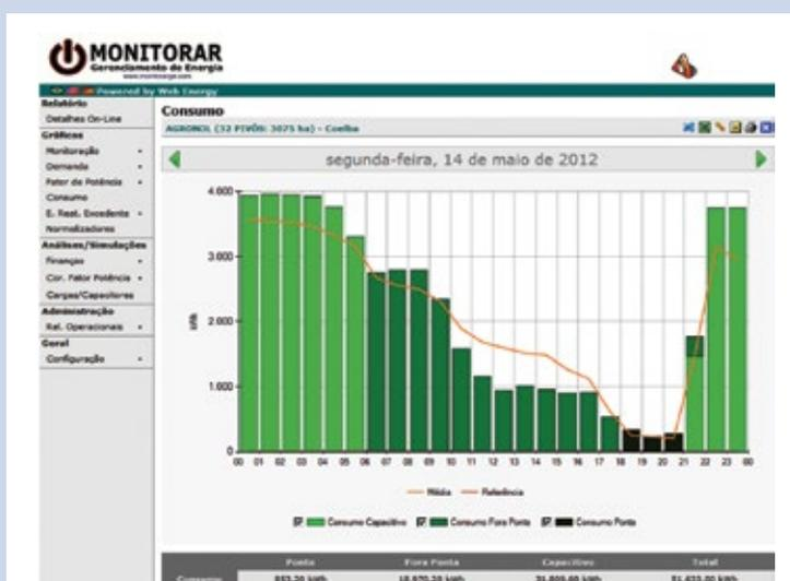
FIGURA 2 – Análise de consumo diário de energia em kWh, nos três postos tarifários (ponta, fora ponta e capacitivo ou reservado)
