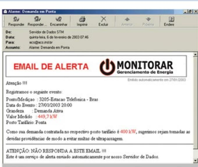
FIGURA 4 – E-mail alerta (consumo na ponta ultrapassou a meta – o limite de 500kWh entre 18h e 21h).
