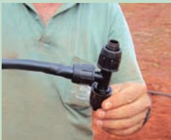
Conexões de compressão garantem a confiabilidade do sistema em polietileno
