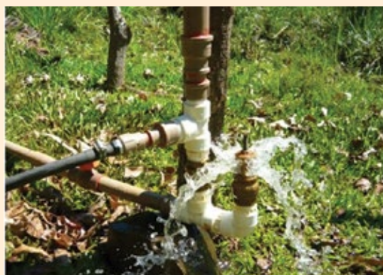
Detalhe do carneiro hidráulico artesanal desenvolvido pela Epagri
