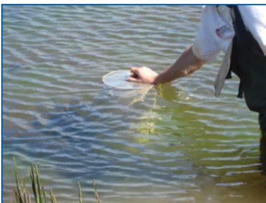
FIGURA 4 Infiltrômetro instalado no fundo do reservatório da barragem
