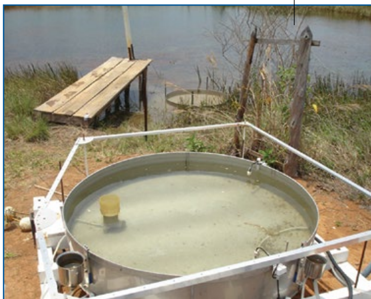
FIGURA 3 Tanques classe "A" instalados dentro e fora do reservatório de uma pequena barragem
