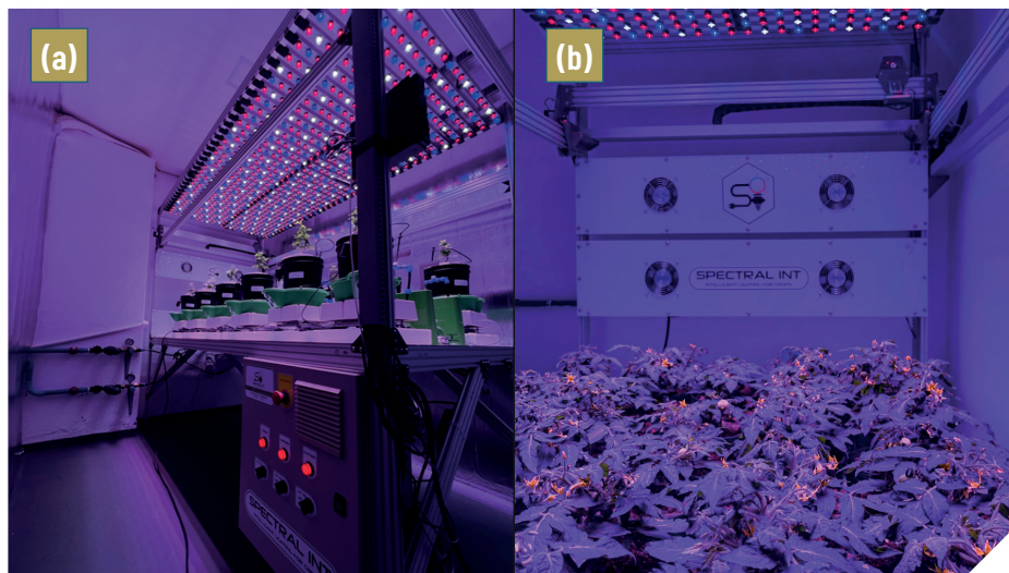
Figura 8 – (a) Câmara com LEDs, controle climático e irrigação automatizada; e (b) plantas em desenvolvimento sob iluminação ajustável e condições ambientais estáveis
