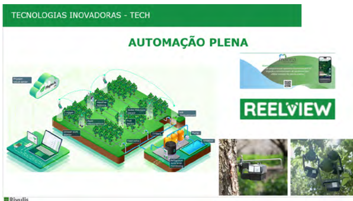
Figura 2 – Projeto de irrigação localizada com automação plena da Rivulis
