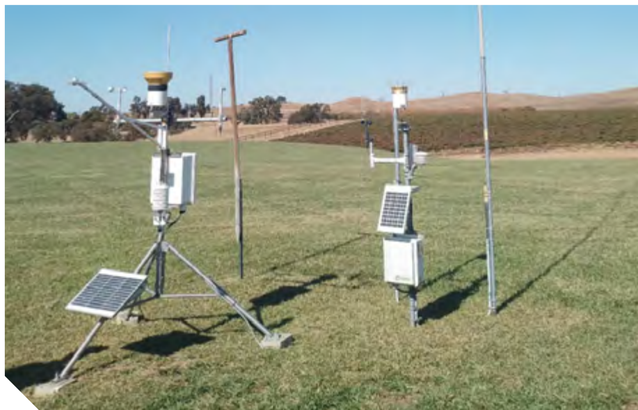
Figura 7 – Estação meteorológica do CIMIS em área de cerca de 3 ha (170 m x 170 m) de gramínea bem manejada para calibração de modelos de estimativa remota de evapotranspiração
