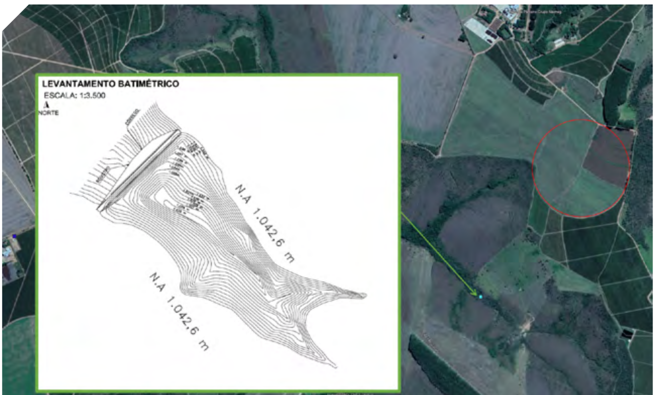
Figura 2 – Detalhe das características planialtimétricas do local de captação após a construção do barramento
