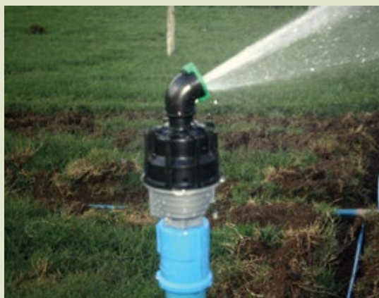
FIGURA 4 – Aspersor de baixa vazão com autocompensação, fluxo regulado – Foto: Evanor
