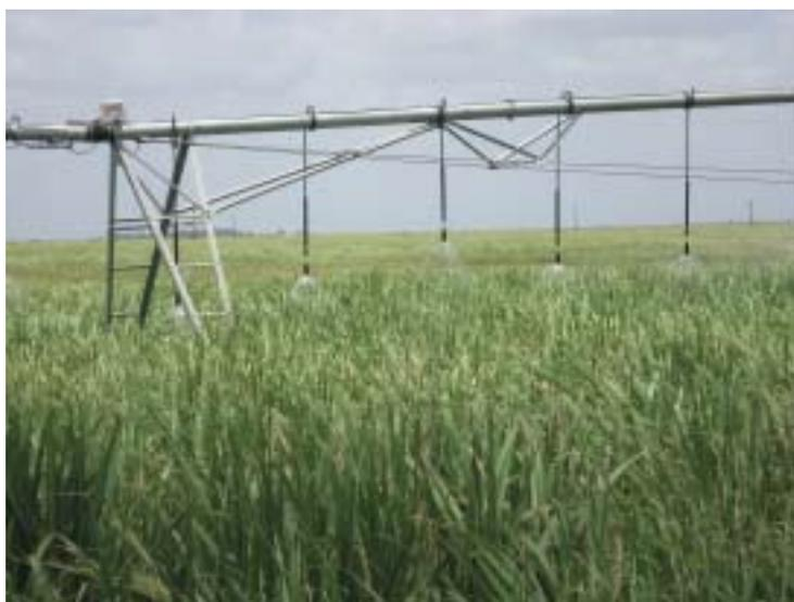
Sistema Linear com aspersores tipo LEPA, irrigando cana-de-açúcar
