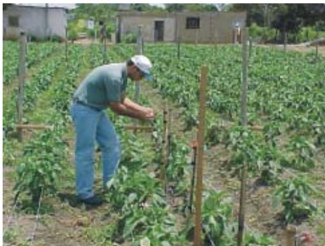
**FIGURA 2** - Acima um sensor Irrigas com cuba transparente verifica se o solo está com tensão de água maior ou menor que a tensão crítica do Irrigas pelo teste de imersão em um frasco com água. Abaixo sensores Irrigas sendo lidos com um aparelho MPI-03
