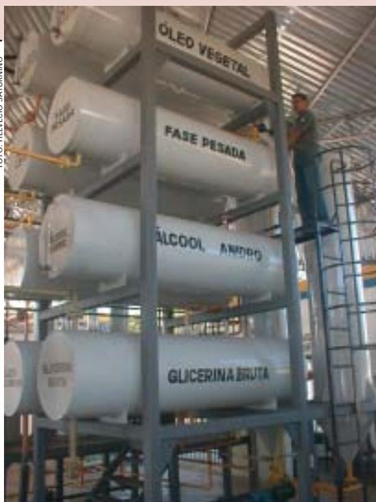
A usina piloto da UFPI tem capacidade para produzir 2.400 litros/dia de biodiesel
