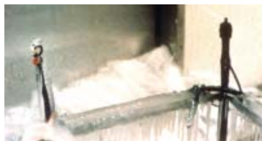
EMISSORES OPERANDO EM CÂMARA A -10°C.
