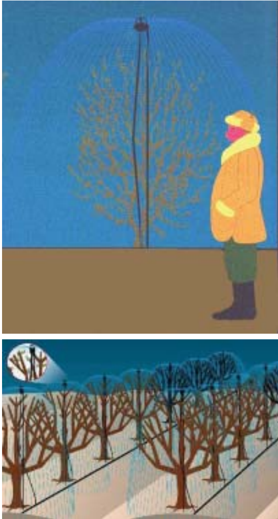
ESQUEMAS DE CONTROLE DE GEADAS POR SISTEMA SOBRECOPA LOCALIZADO.
