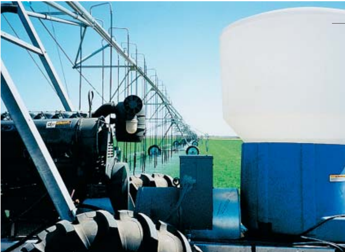
Tanque e injetor de produtos químicos acoplados ao cart central do sistema de irrigação linear Valley
