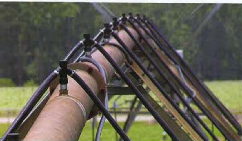
FIGURA 17 – Posicionamento dos pendurais nos tirantes dos pivôs (aumento do padrão molhado)
