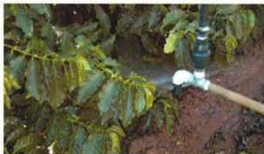
FIGURA 9 – Emissores tipo Fun Spray , utilizados na irrigação de café com pivô central
