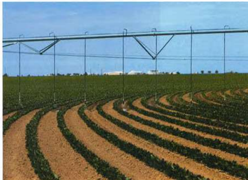
Figura 4 – Sistema LEPA de irrigação em pivô central
