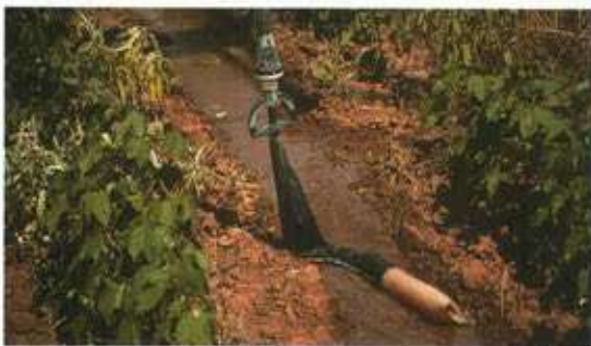
FIGURA 7 – Sistema LEPA com emissor Super Spray e meia de manta butílica e nylon
