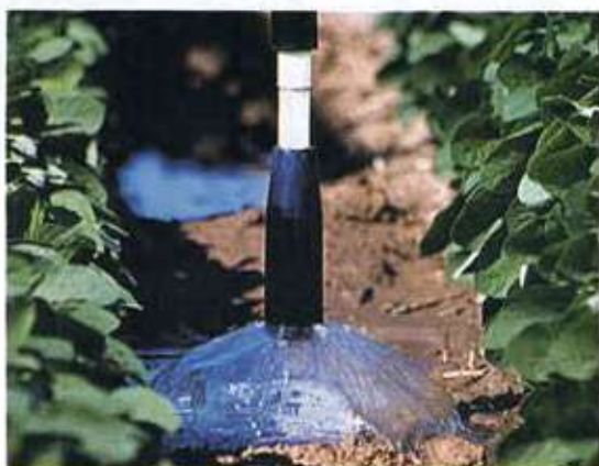
FIGURA 2 – Sistema LEPA com emissor Quad Spray em pivô central
