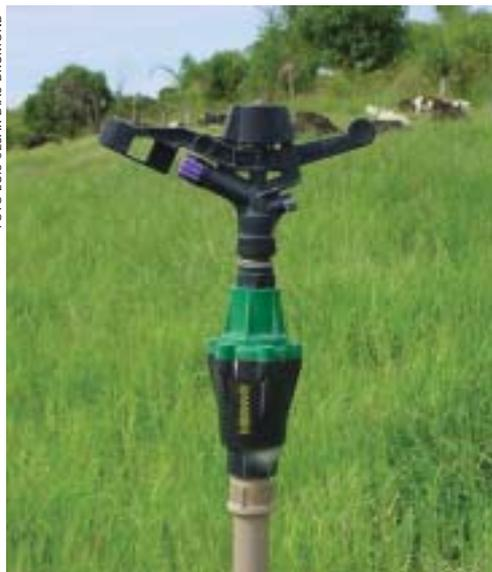
**FIGURA 1** – Vista do aspersor e do regulador de pressão
