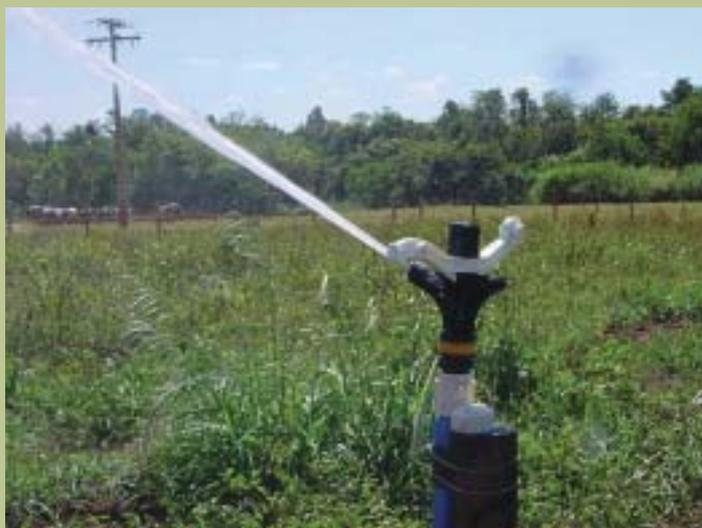
Aspersor Senninger - Modelo 8025RD-1 1/4" M operando em sistema de irrigação em malha
