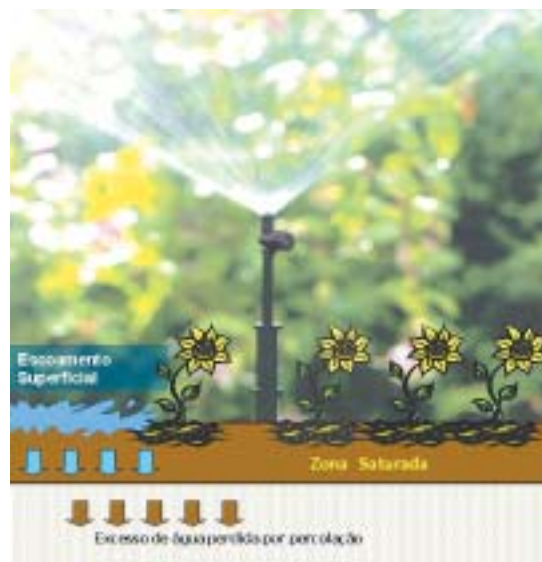
FIGURA 1 – Esquema de perdas de água que ocorrem no processo de irrigação
