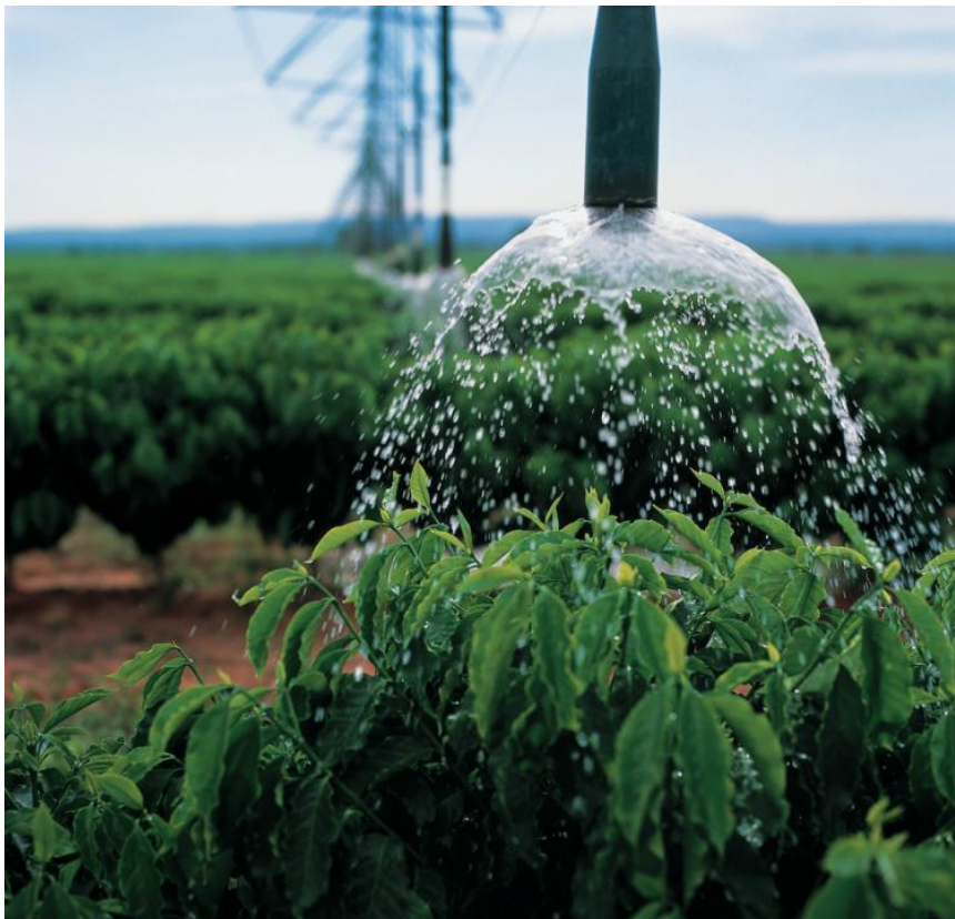
Figura 7. Pivô central. Aspensor tipo Lepa irrigando a cultura de café.
